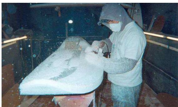
Etape 7 : travail du pont au rabot électrique pour coucher les cares
