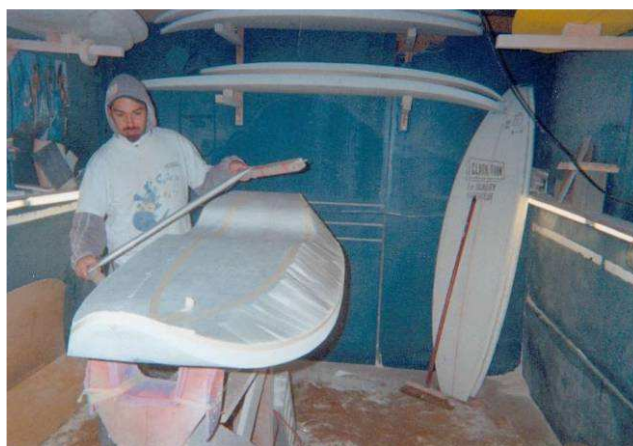
Etape 4 : travail de dégrossissage au fil chaud pour les angles supérieurs
