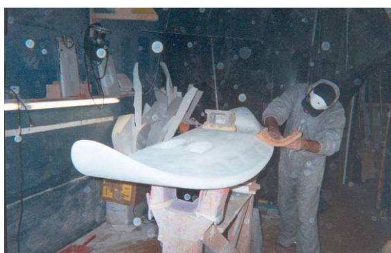
Etape 10 : les cares et volumes sont définitifs, lissage des angles au stimer
