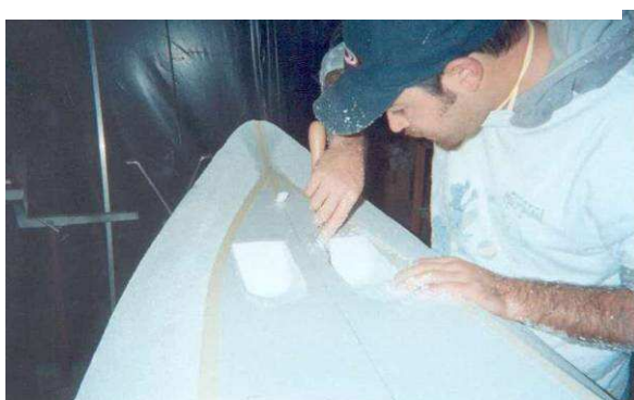
Etape 9 : façonnage des fosses de pieds et de la cuvette
