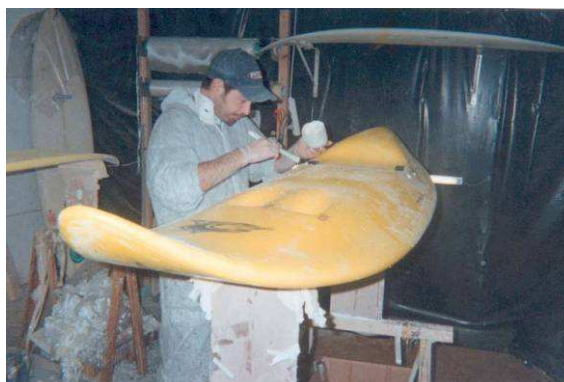
Etape 12 : stratification et pose des inserts. Les finitions se font par un glaçage et ponçage à l'eau de toute la surface.
